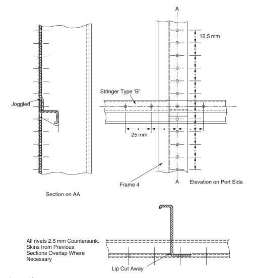
Fig. A.14(d) Detail 4, Frame 4.
